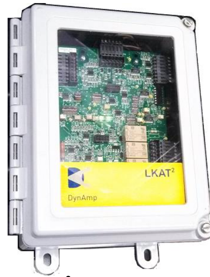
LKAT 2 Metering Unit
